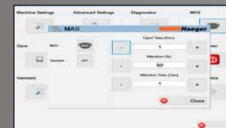
**MAS Control screen:** Controllo Alimentazione Automatica MAS: L'operatore può attivare o disattivare la tazza vibrante e può variare i tempi di espulsione fasteners, di vibrazione dal Touch-Screen.
