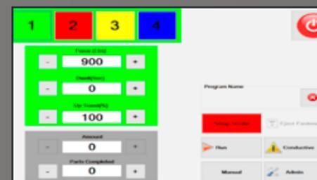
**Multi-Station:** La Multi-Station è un'opzione che consente all'operatore di inserire diversi fasteners in un programma. Ogni stazione può essere configurata con ogni singola forza, tempo di sosta punzone e la regolazione corsa di risalita del punzone.
