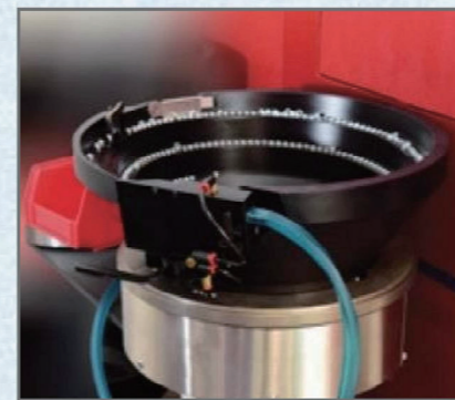
MAS 350 ファスナー自動供給装置、 ファスナーが変わっても各ファスナー用の自動ツールに工具なしで交換可能
