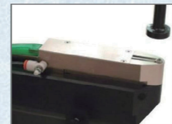
ボトム自動供給装置 ナットを下側より自動供給し圧入する場合
